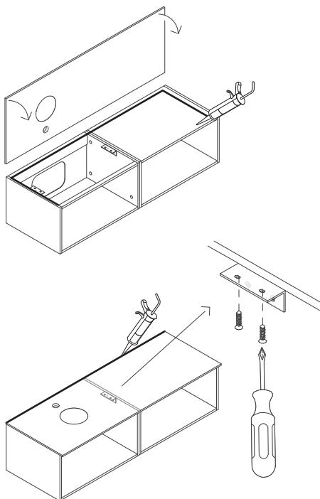
Per il fissaggio usare del silicone
