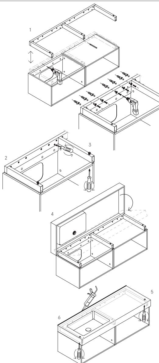
Posizionamento e fissaggio dei top sospesi | Positioning and fixing of suspended tops
