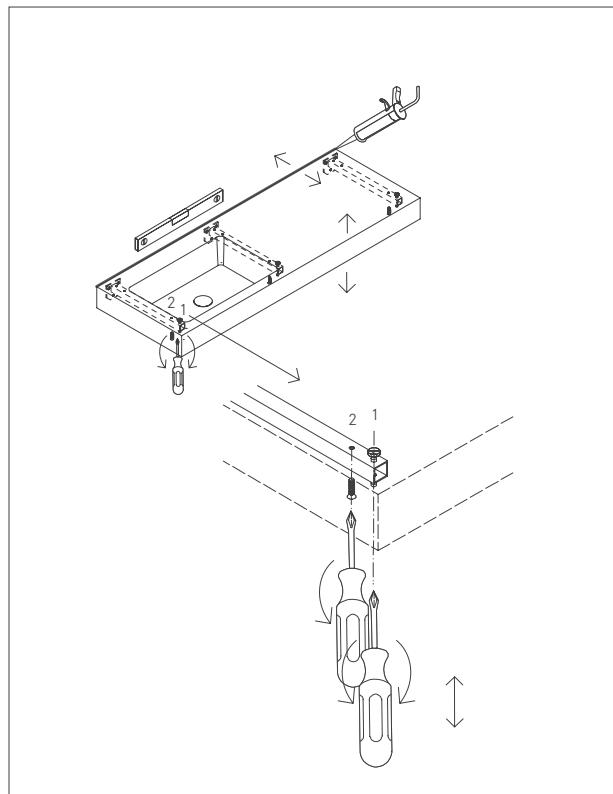
Posizionamento e fissaggio dei lavabi | Positioning and securing of washbasins
