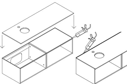
Per il fissaggio usare del silicone
