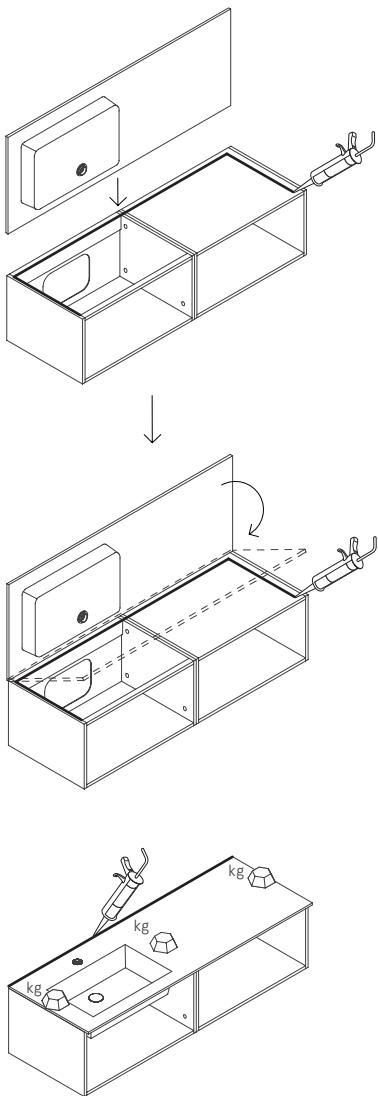
Posizionamento e fissaggio dei top | Positioning and fixing of tops | Positionnement et fixation des plans | Размещение и крепление столешниц
